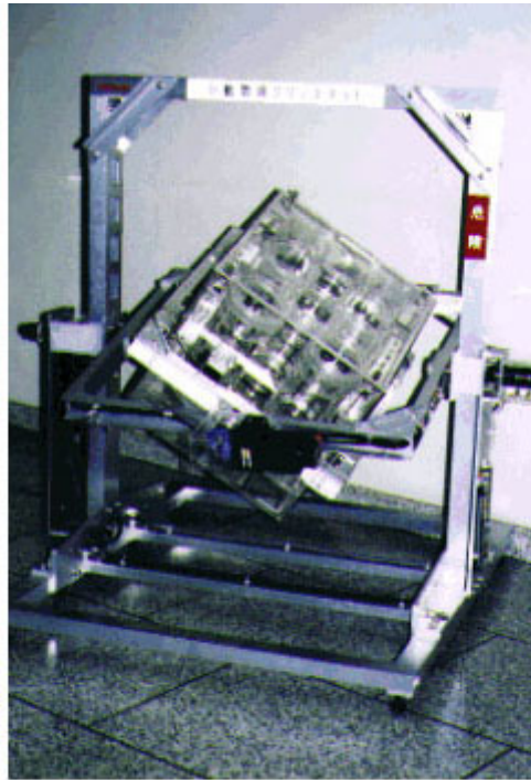
写真1 小動物用擬微小重力装置クリノスタット：中央の箱が3次元回転して擬微小重力状態をつくる。
