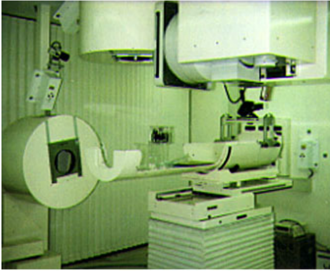
シミュレーション室の様子。左端部及び左上方部の円筒部を各々水平ビーム、垂直ビームに見立てた位置決め作業が可能です。
