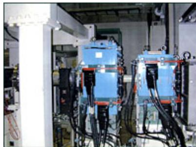
上流に設置された走査電磁石 (スポットビームを水平及び垂直方向に偏向させる電磁石)。
