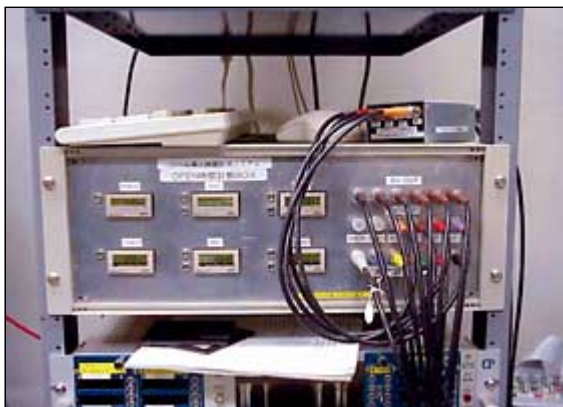
図3 治療室に導入される炭素粒子数と導入時間の積を求めるモニタ。この積は中性子発生数と相関関係があり、加
