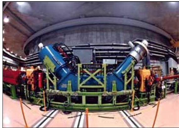
図8 電子冷却装置(ビームクーラー)の全貌。大強度ビームや高品質ビームを得るための道具となります。
