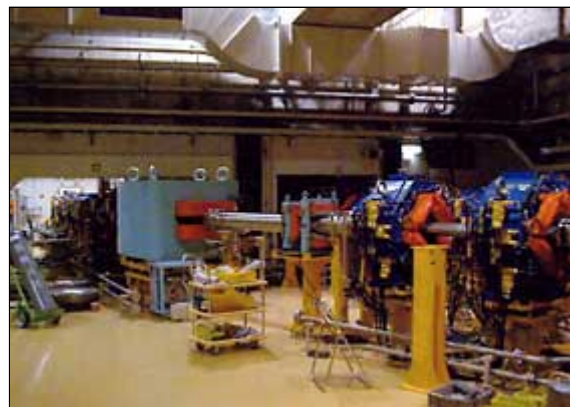
図4 望む粒子( ^{11}\text{C} 等)を分離精製する二次ビームライン。各種物理実験にも利用されます。
