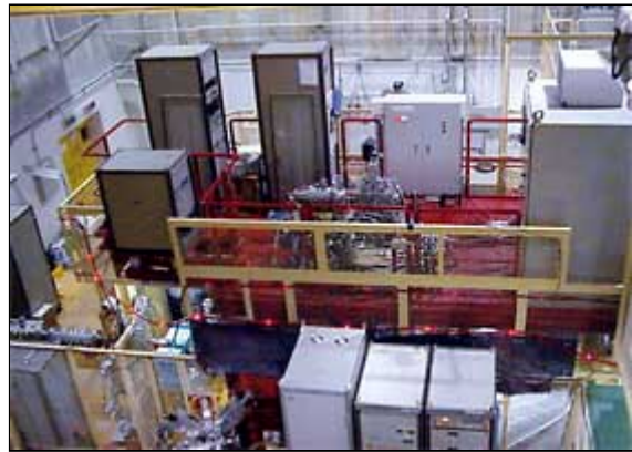
図6 Arより重い粒子の生成を特に狙って製作された18GHz-ECRイオン源。一番重いイオンは(目下)Xeです。
