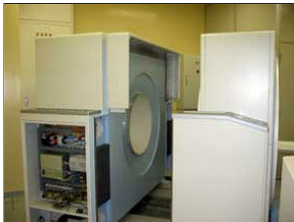
図-2 PET-CTガントリ部。メンテナンス時にはPETガントリが後方に移動する(右)。
