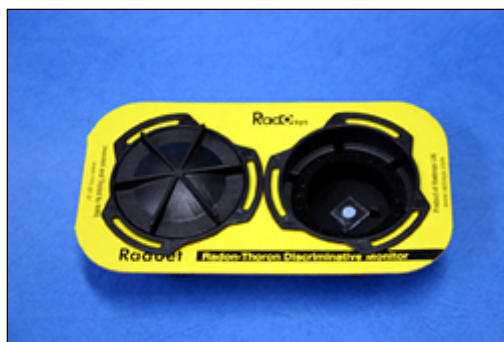
写真-1 放医研が共同開発したパッシブ型ラドン・トロン弁別測定器(ラデュエット)
