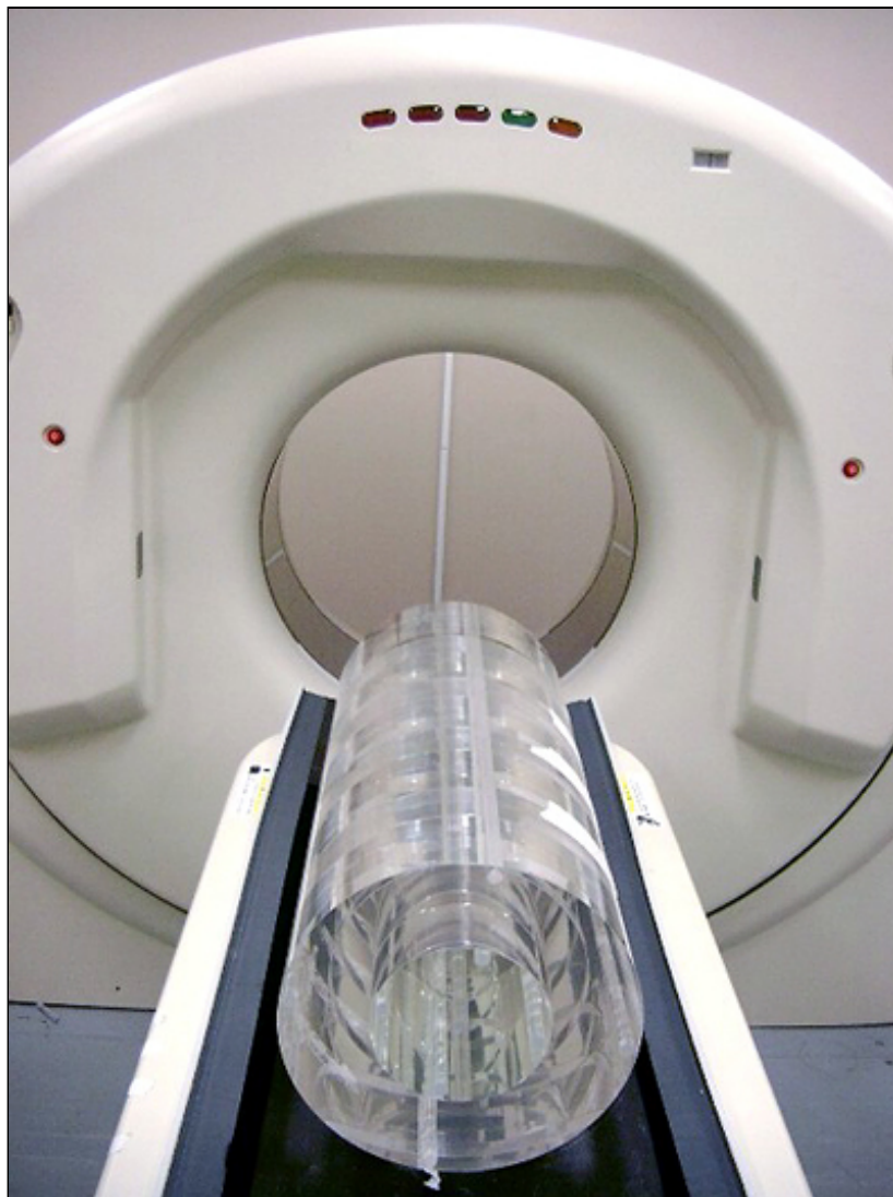
図-1 体幹部用900mm長線量評価用ファントムと、4次元CTの写真。
