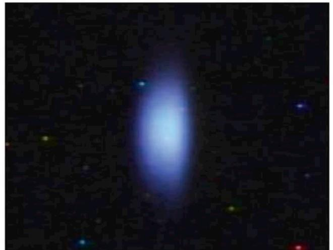
図 2 蛍光膜プロファイルモニタで観測されたビームプロファイル。
