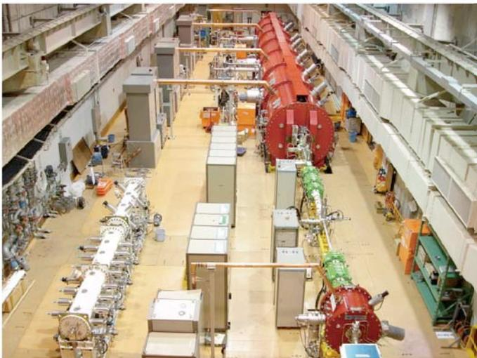
現在の HIMAC 線形加速器室。既設アルバレ型ドリフトチューブ線形加速器(右手奥)と移設された高効率小型線形加速器(左手前)。
