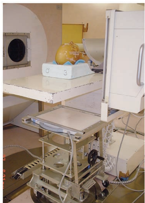
図2: 開発したFPD用架台(垂直方向用)従来のII管用架台に比べて大幅に軽量化でき、治療時の作業も改善される。
