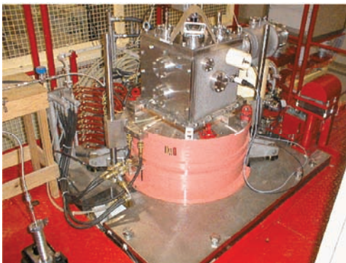
図1 18GHzのマイクロ波を使用したECRイオン源(NIRS-HEC)
