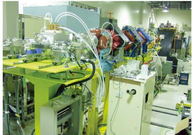
図2 新しいターゲット部。その直上流には最近追加設置した垂直・水平のステアリングマグネットとさらにその上流に黒い色の4極電磁石がある。
