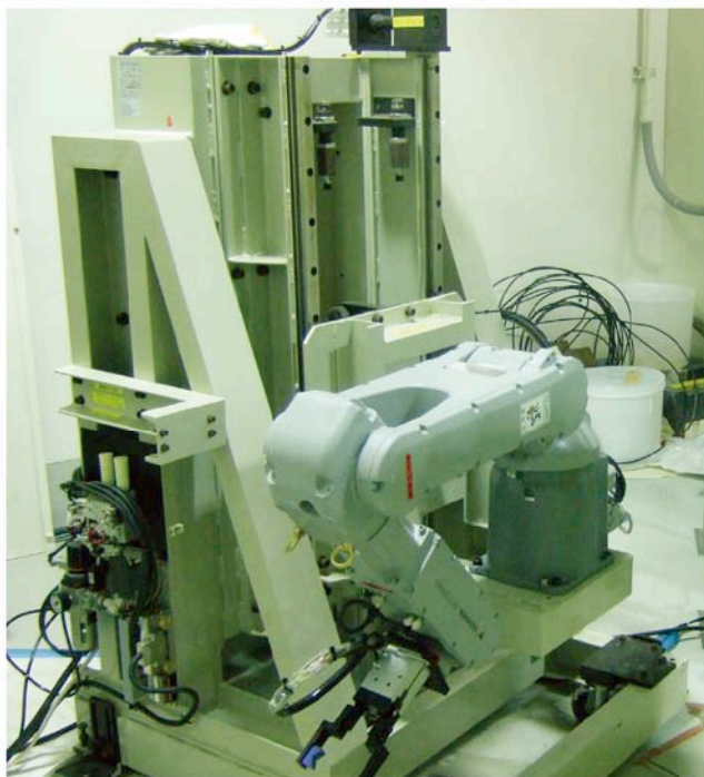
図1 水平照射コース(C4)のターゲット部の傍に設置された新しいロボットアーム
