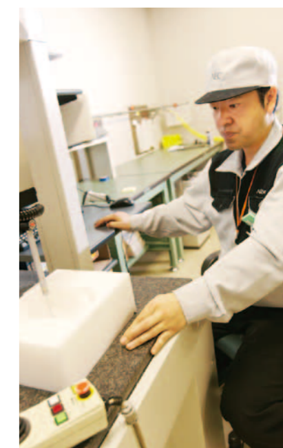
仕上がったボラスを検査する。交差に収まらなかったものは破棄される。
