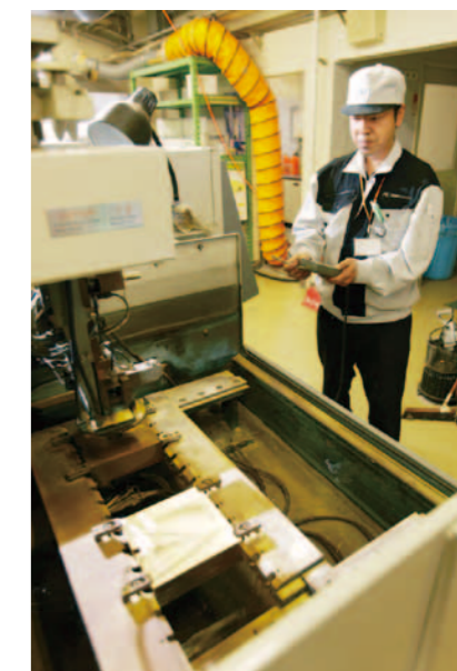
コリメータの型を抜くワイヤ放電加工機にデータを入力し起動させる。「起動時にワイヤがうまく通らないうちが修正できないんですよ」1日のうちでもっとも緊張する瞬間だ。
