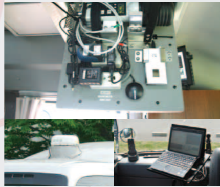
REMAT 隊員の安全を遠隔地からでも確保するための、ラジプロブシステム&衛星通話通信システムを新型車両の3台すべてに装備。GPSによる位置情報、放射線量率、放射線のエネルギースペクトルによる核種同定をPC上に表示し、災害対策本部はリアルタイムで情報を得て、安全確保のための的確な指示を出すことができます。
