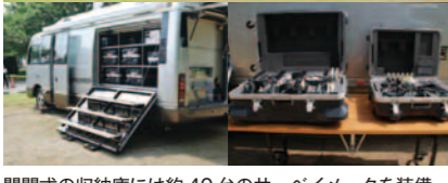
開閉式の収納庫には約40台のサーベイメータを装備。
