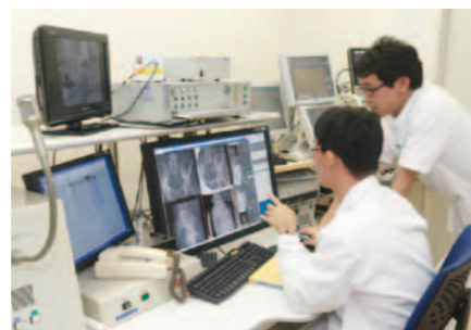
治療計画で撮られた画像と重粒子線治療室で撮られた画像の2枚を骨の位置でぴったりと合わせます。(モニター室)
