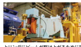
上リングにビームが駆け上がるために設けられた偏向電磁石
