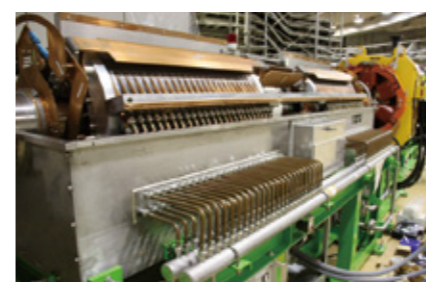
メンテナンス中の高周波加速空洞。シンクロトロン的心臓部ともいえる部分で、粒子がここを通るたびに一気に加速されていく。
