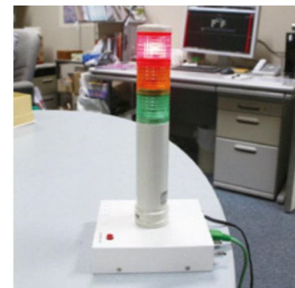
トラブル発生の際に赤ランプが点滅するパトロールランプ
