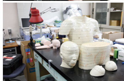
2次がんと線量の関係を解明するために必要な模擬人体、ファントム
