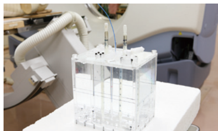
ポリマーゲル線量計の扱いは酸素に触れないように行う
