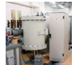
国内最強レベルの中性子強度(平均2MeV)を誇る中性子照射場
