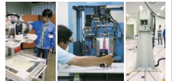
様々な線量・線量率で照射可能なX線・γ線照射装置群
