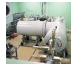
微量元素を高感度で検出できる多元素同時分析装置
