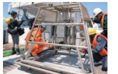
東電福島第一原子力発電所沖におけるマルチプルコアラーを用いた採泥作業の様子(東京海洋大学練習船「海鷹丸」)
