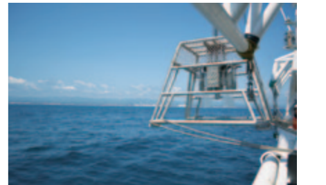
東電福島第一原子力発電所沖におけるマルチプルコアラーを用いた採泥作業の様子(東京海洋大学練習船「海鷹丸」)
