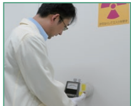
④ 放射線発生装置を動かし、室外から測定を行う(6カ月点検)
