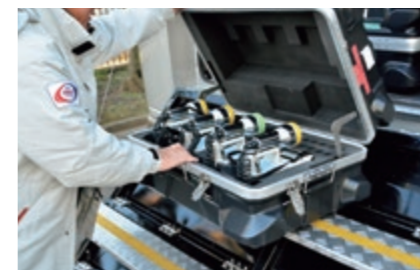
支援車に搭載されたサーベイメータ
