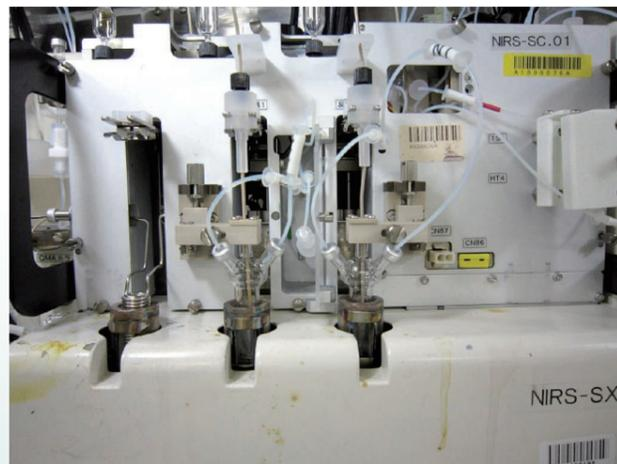
図1:自動合成装置(左)とクリーンルームで業務を行うスタッフ(右)
