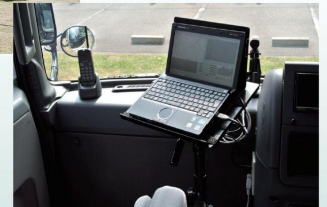
図10:支援車内に設置されたラジプローブ
