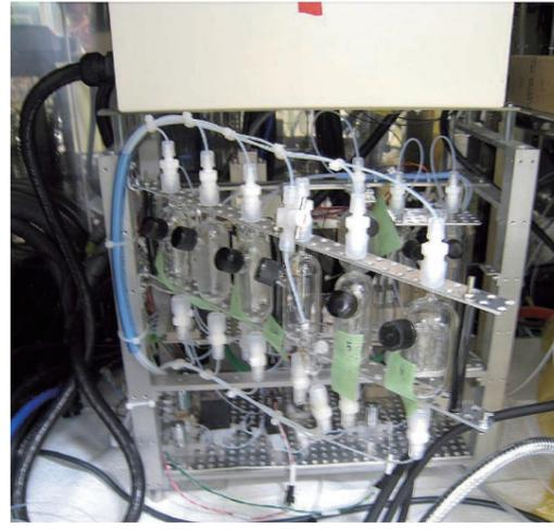
図32: 自動回収分離装置
