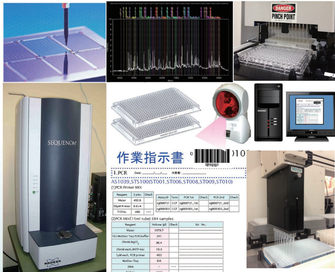
図5: 質量分析計を用いたヌクレオチドタイピングシステム
