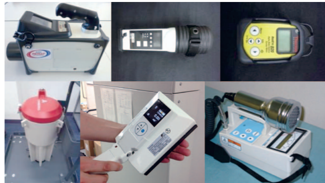
図4: REMAT 装備計測器の一部 可搬型のものを用意している (上段左から: γ線核種同定装置、γ線・中性子線線量率計、α/β/γ線汚染サーベイメータ、下段左から: 可搬式ウェル型NaI測定装置、半導体式α/βサーベイメータ、GMサーベイメータ)。
