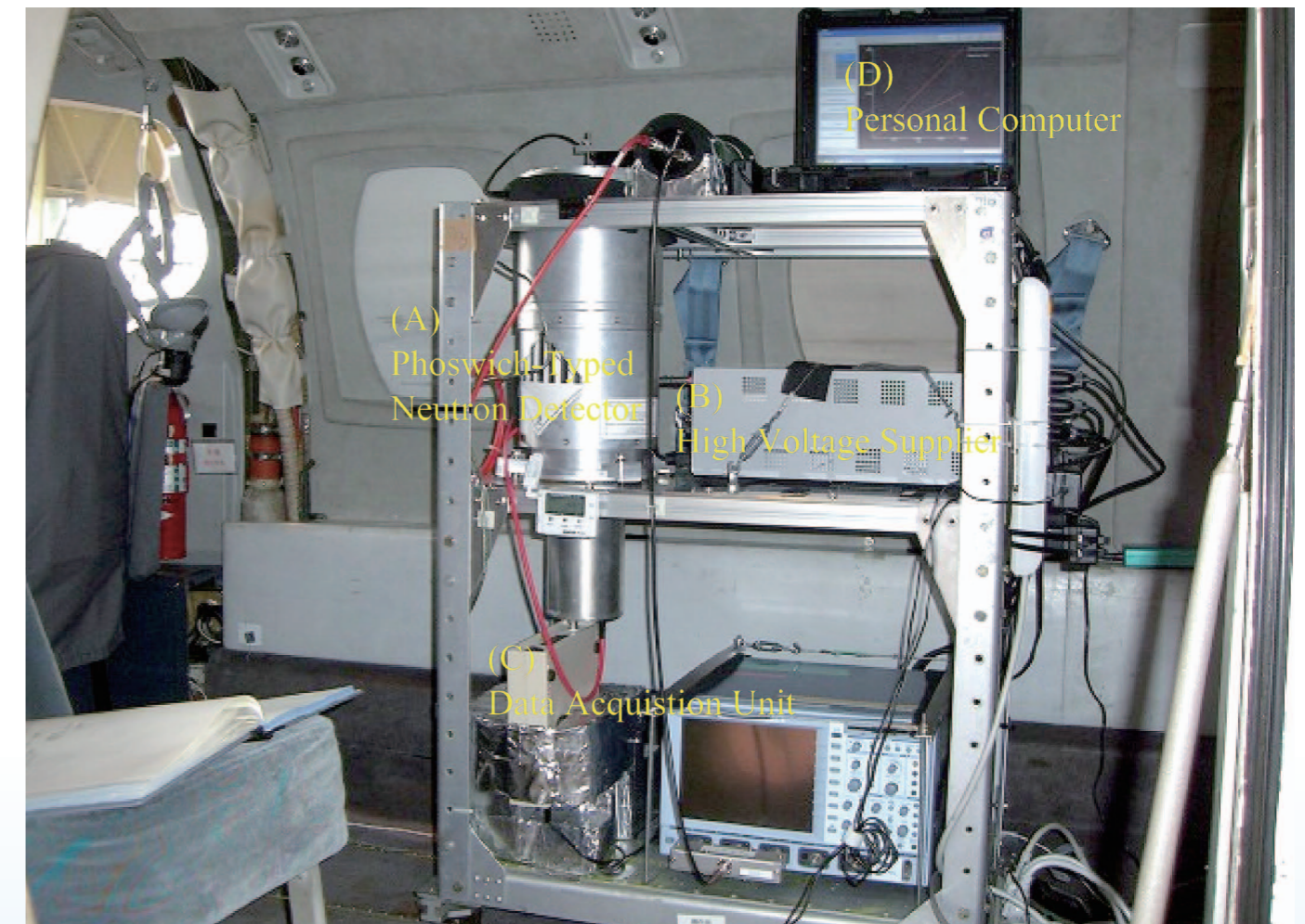
図1: 独自に開発したホスウィッチ型検出器を搭載した 航空機搭載実験中の航空機内の様子
