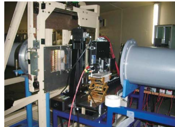
図5:サイクロトロンに広く平坦なビームラインを整備し、ビームの特性を評価。
