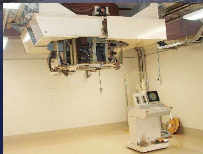
◀ 10 MeV中性子、照射野(20 cm×20 cm)の 生物照射実験用照射ポート室
