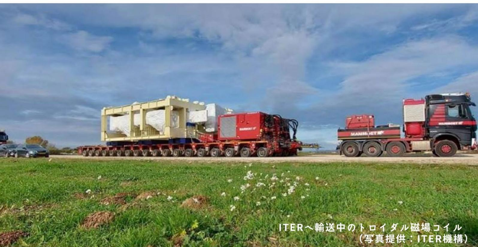
ITERへ輸送中のトロイダル磁場コイル
