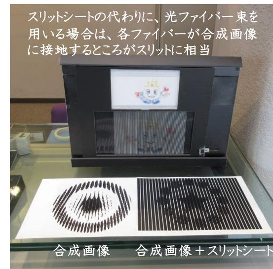
スリットシートの代わりに、光ファイバー束を用いる場合は、各ファイバーが合成画像に接地するところがスリットに相当
