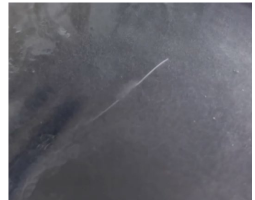
霧箱で観察された自然放射線 これはミュオンでしょうか
