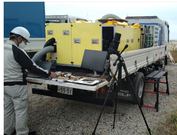
橋梁用レーザー打音検査車両(写真は岡田 大 主幹技術員)
