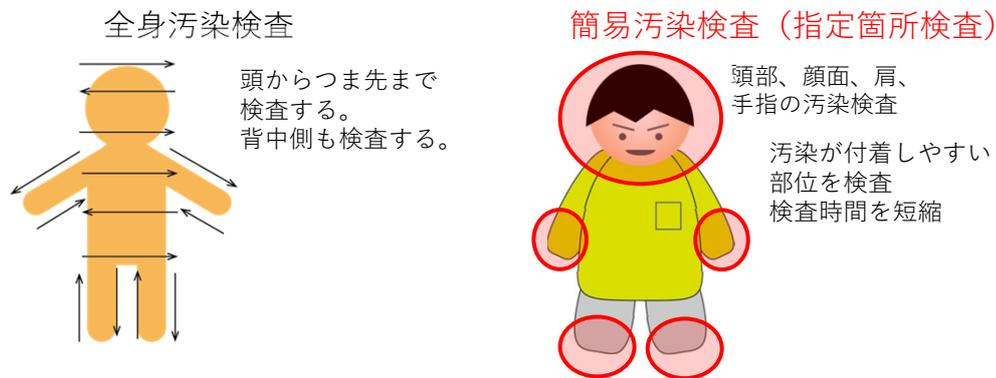
身体汚染検査では、GM計数管式サーベイメーターを使用して、全身を測定します。原則として、検査は2人1組で行い、1人が測定を、もう1人が記録を行います。要員に余裕があれば、検査員2人が協力して検査し、時間短縮が可能です。
