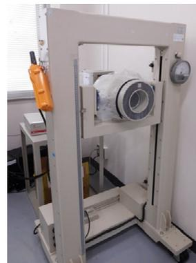
ファントムによる校正を行い、正確な計測できるように準備しておく
