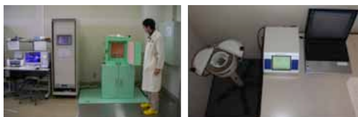
図 1 Ge 検出器（左）と NaI(Tl) スペクトロメーター（右、農林水産省「放射性物質の分析について」（平成 23 年 12 月）18 ページより転載）
