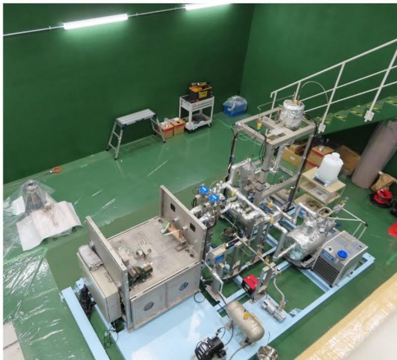
実際に冷却水を漏洩させた時の衝撃対策を考慮してピットの中に装置を設置しました。
