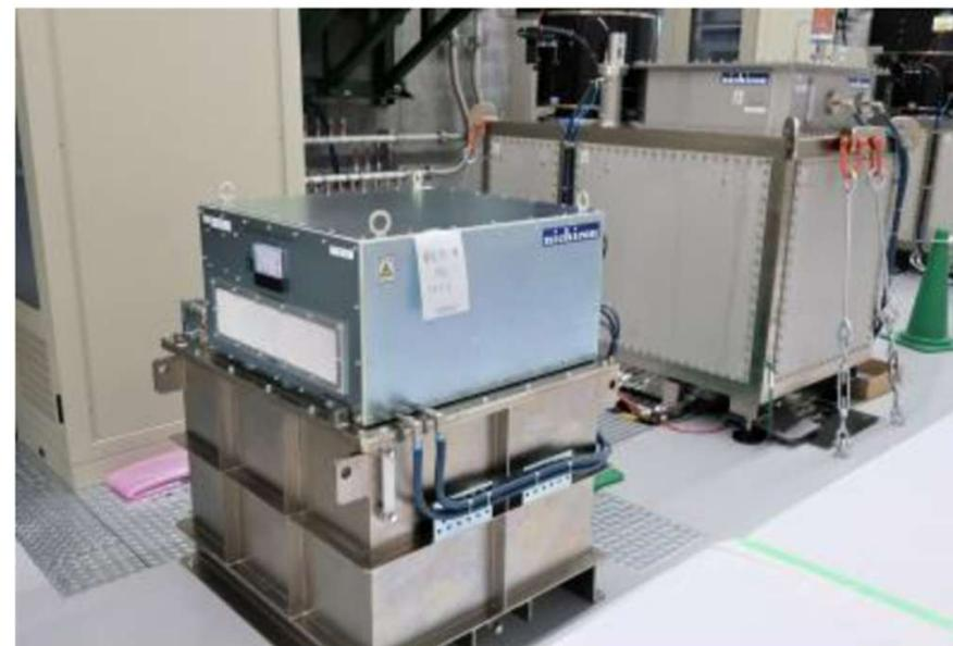
Cバンドクライストロンモジュレータ・高精度PFN充電器 (20台)
