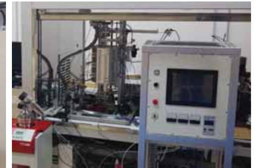
ベリリウム-水蒸気反応試験装置
