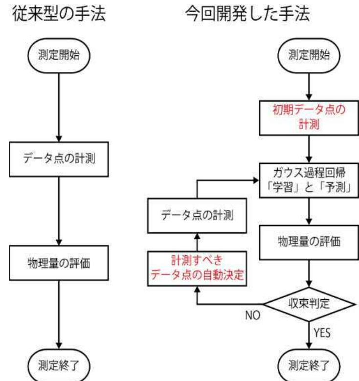
図1 従来型のX線スペクトル測定と今回開発した手法の比較。本手法では、ガウス過程回帰を用いて実験データを「学習」し、X線スペクトルを「予測」することで、計測すべきエネルギー点を自動的に決定することができます。
