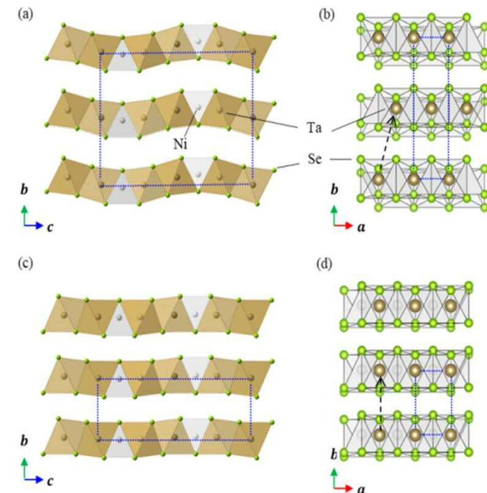
図1 (a)(b) 二方向から見た1気圧30℃における $Ta_2NiSe_5$ の結晶構造。(c)(d) 4万気圧-73℃における結晶構造。(b)(d)のb軸方向の上下の積層関係を見比べると、例えばTa原子の位置は(b)では斜め上にあるのに対して(d)では真上に位置しています(図中点線矢印)。これは層全体がスライドしたことに対応します。
