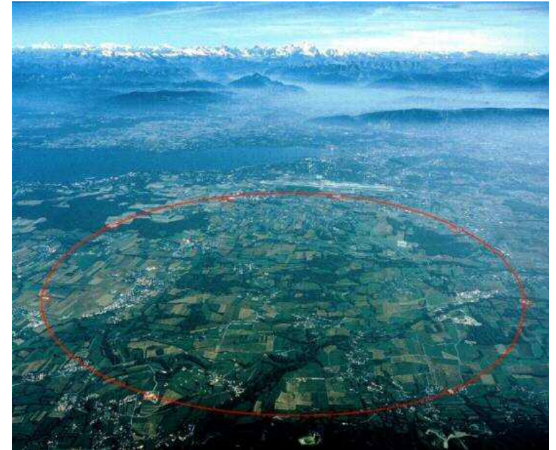
CERNの大型ハドロン衝突型加速器(LHC)は、スイスのジュネーブ郊外にあり、スイス-フランス国境にまたがって地下に建設されています。多くの加速器から構成され、最大のもは周長約27kmに及びます(赤線)。 http://atlas.kek.jp/public/overview/LHCproject-1.html より
