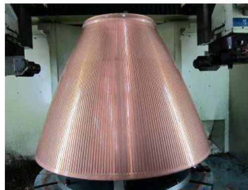
特殊銅合金製の燃焼室のチャンバー
