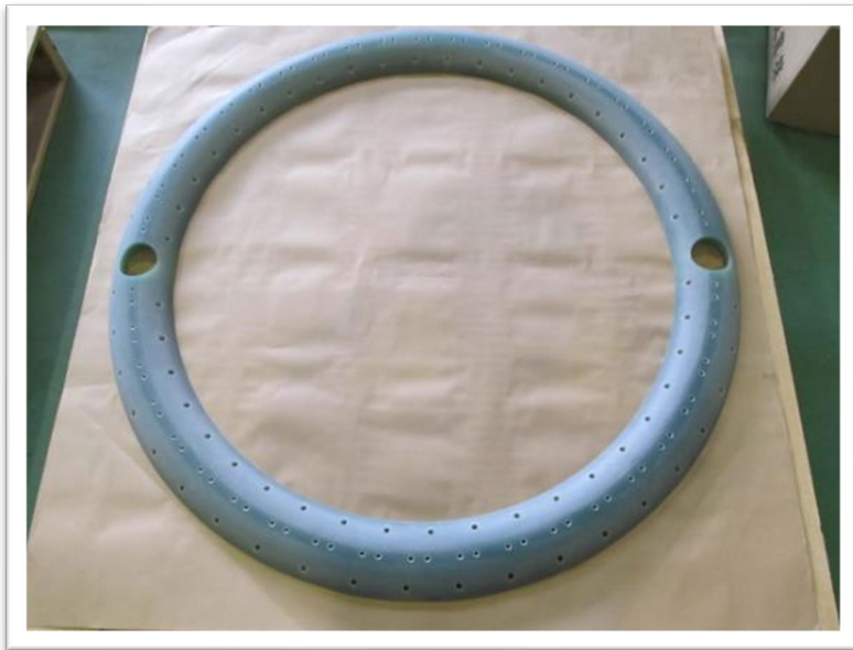
東京大学大学院TS-4U実験フラックスコア用(直径約 1 m) 小野 靖研究室様 ご提供
