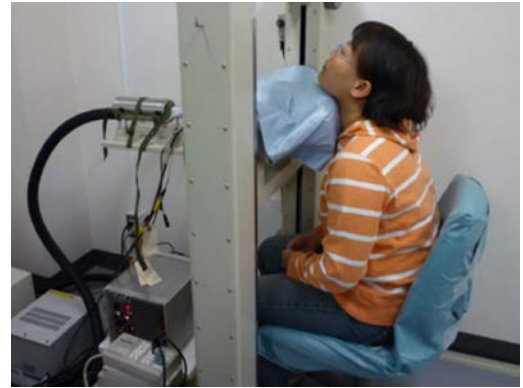
図 2 甲状腺モニタを使用した測定の様子
