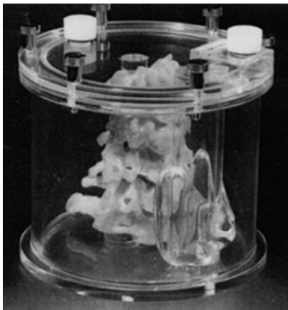
図 3 甲状腺を模擬した物理ファントム
