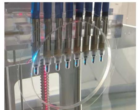
図 12 水深 2.9 mm から測定可能な新型薄窓水ファントム装置
