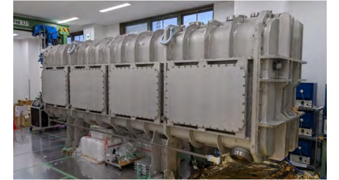
クライオモジュール外観 (超伝導リニアックの本体)
