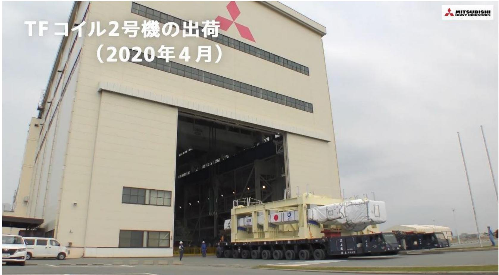
極低温高靱性材料開発、厚肉ステンレス鋼溶接、CIC導体製作、高精度巻線、巻線位置管理、超伝導巻線巨大加工機による構造物の高精度加工等、10年以上にわたるR&Dの成果が高さ16.5m、幅9m、総重量300トンの巨大なITER TFコイルに結晶。
