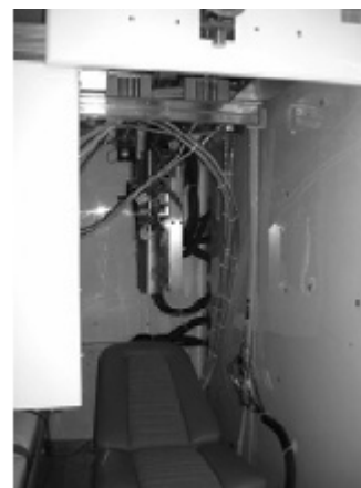
図2 6本のGe半導体検出器を用いた不均等分布対応WBC
