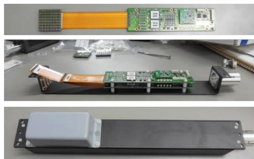
図 5 実証機用 PET 検出器。上から検出器モジュール(MPPC と FE 回路)、検出器モジュールをシールドボックスに組み込んだ状態、完成形
