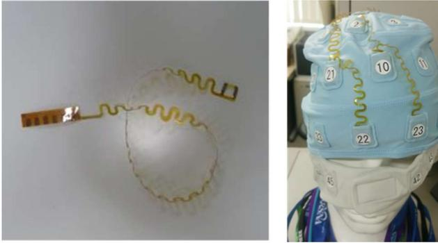
Fig. 4. フレキシブルケーブルと専用装具に固定した状態
