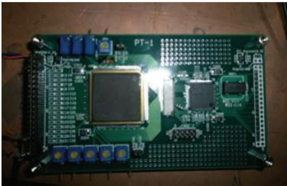
図 8.32 チャンネル-TOT-ASIC と評価ボード
