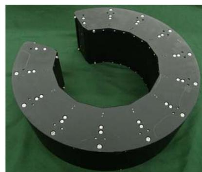
図8 原理検証用ガントリ
