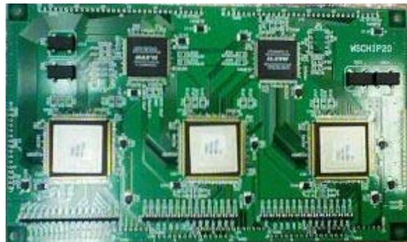
図5 48ch WS-ASIC ボード
