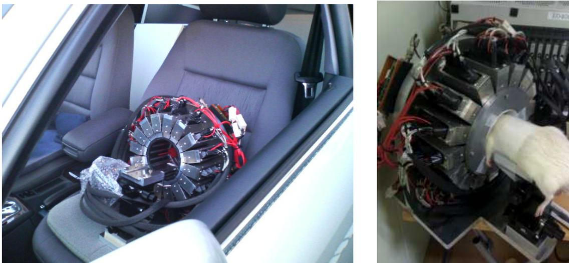
Fig. 3 移動中の動物PET装置の写真（左）とラットを撮像中の動物PET装置の写真（右）
