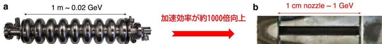
図2：a：RF空洞型加速器、b：LWFA用のガスノズル。1 GeV = 10^9 eV
