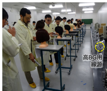
数MBq程度の密封線源を用いて 高BG環境( \sim 0.5 \mu\text{Sv h}^{-1} )を模擬
